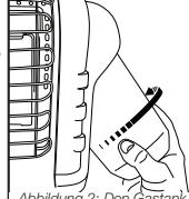
Abbildung 2: Den Gastank befestigen
