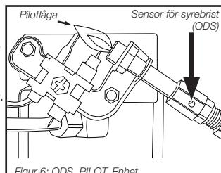
hållaren) med en dammsugare eller lufttryck genom pilotens hål som visas av pilarna i figur 6. **VARNING:** Använd aldrig nälar, trådar eller liknande cylindriska föremål för att rengöra piloten och undvik att skada den kalibrerade mynningen som kontrollerar gasflödet.
