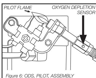
8. Inspicér ogrens pilotrøret (monteret på beslaget) ved hjælp af et vakuum eller brug lufttryk gennem hullerne i pilotrøret angivet med pilene i figur 6. ADVARSEL: Brug aldrig brug nåle, ledninger eller lignende cylinderformede objekter til at rense pilotrøret for at undgå at beskadige den kalibrerede blænde, der styrer gas-flowet.
